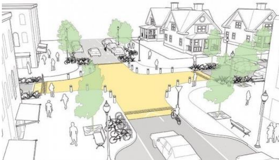
Figura 27. Esquematização de uma interseção elevada
